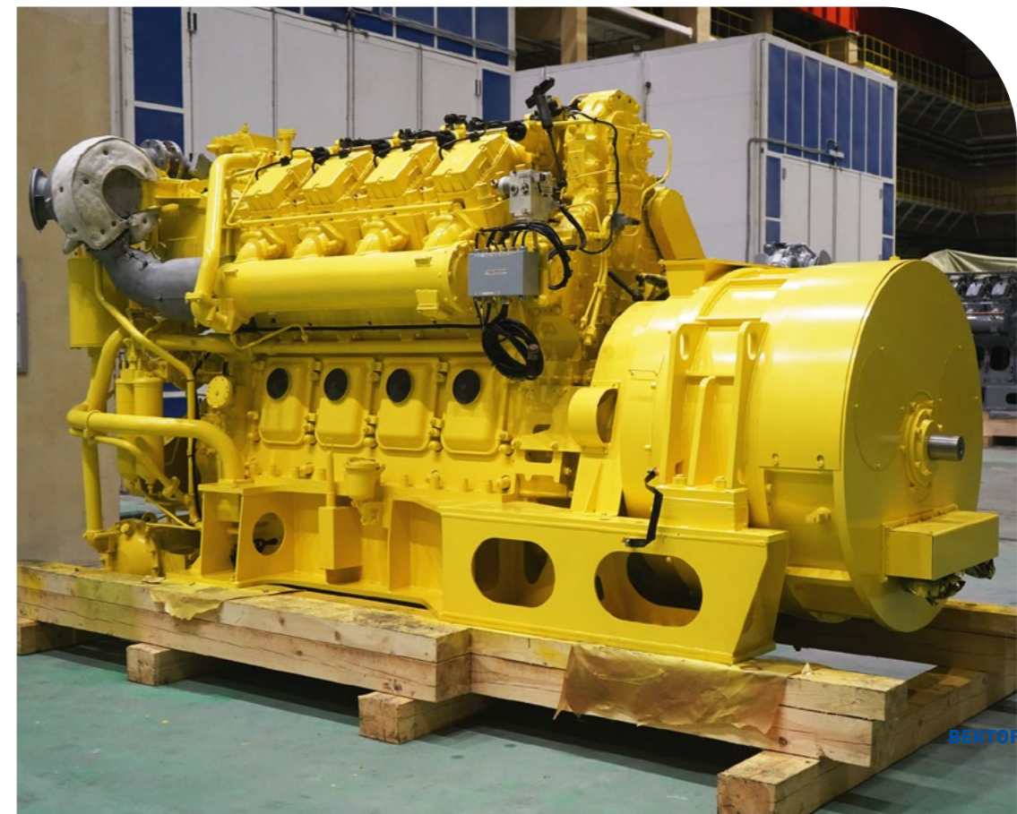
< Среднеоборотный дизель-генератор для БелАЗа 16-36ДГ
