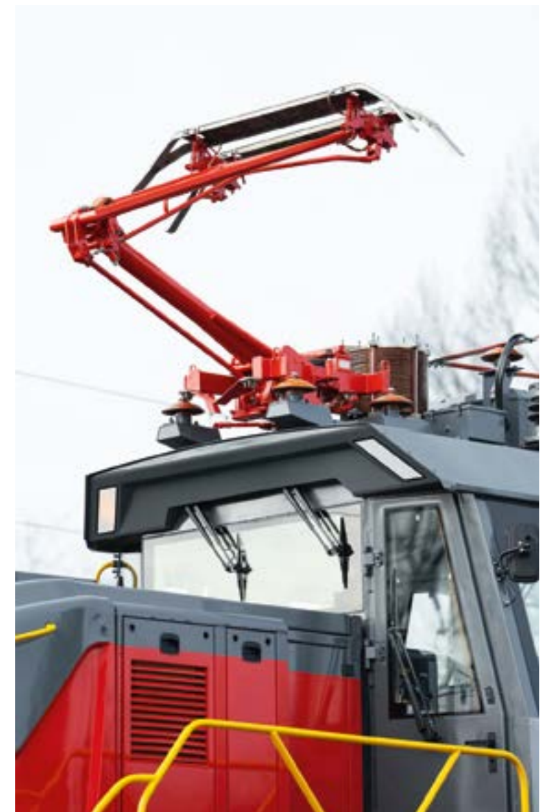
▲ Кабина управления с установленным крышевым оборудованием
