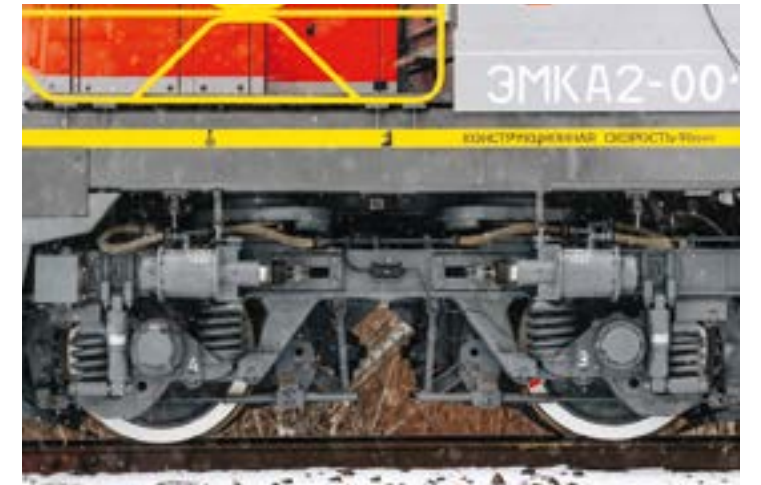
▲ Тележка оборудована тормозной рычажной передачей с автоматическим стояночным тормозом
