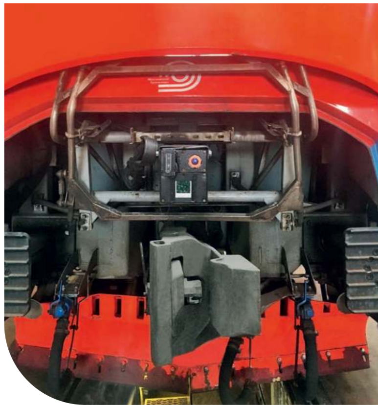
▲ Расположение нижнего блока сенсоров над автосцепкой
