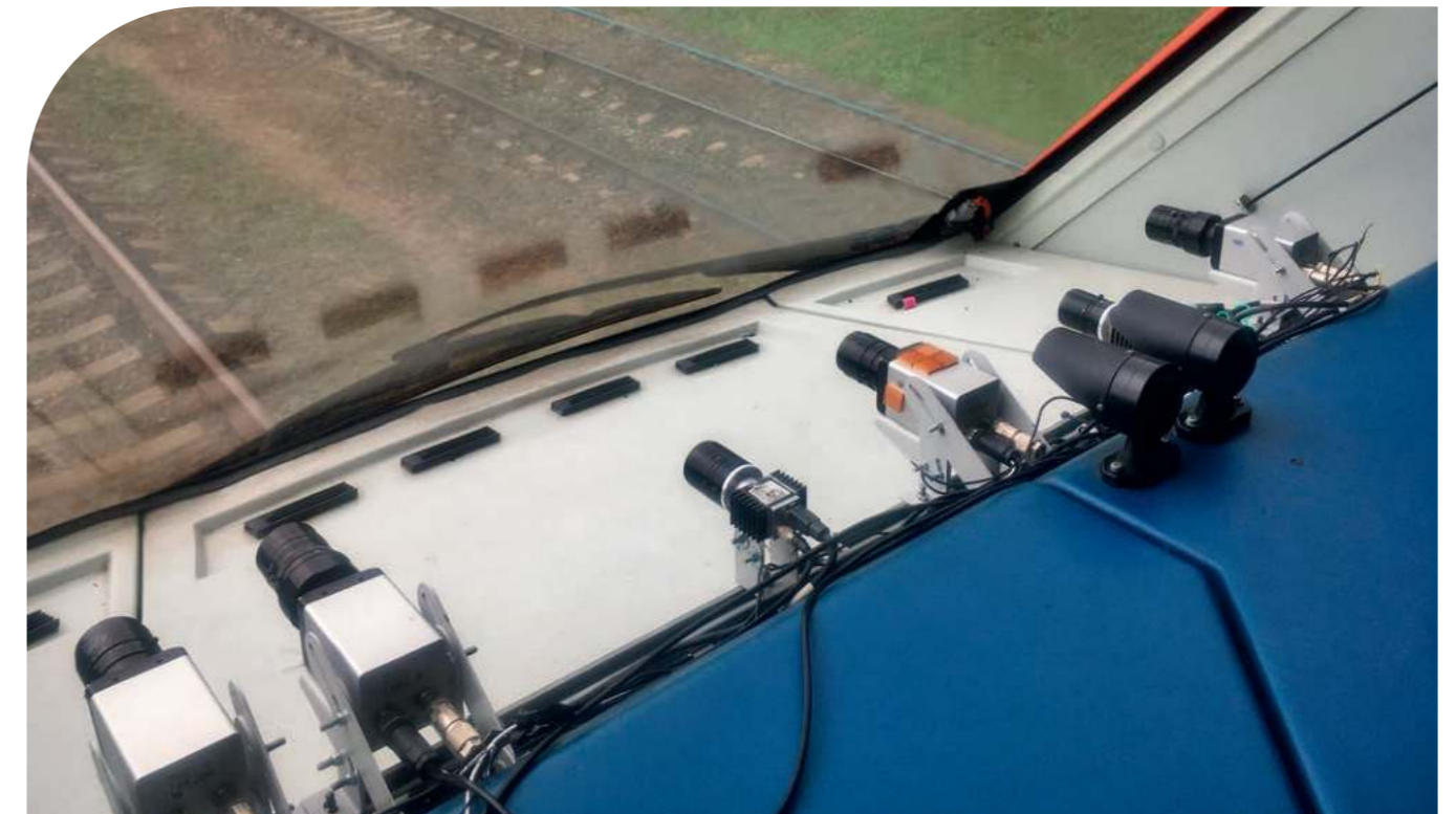
▼ Расположение камер в кабине машиниста
