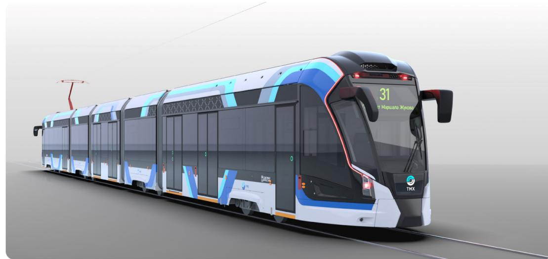
**Наличие двух кабин и расположение дверей по обе стороны бортов** позволяет эксплуатировать вагон «в режиме челнока» на линиях, где нет разворотных колец
