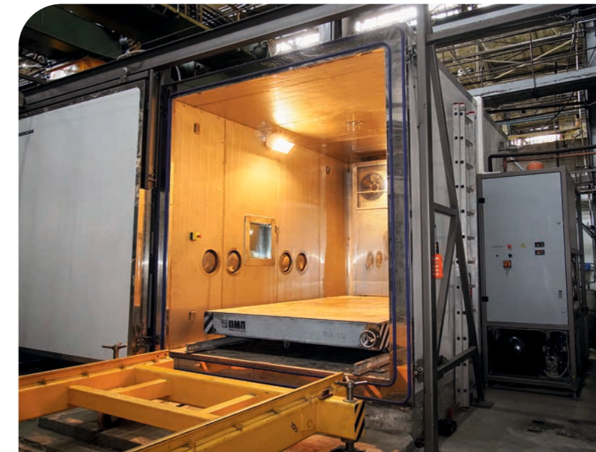
▲ Климатическая камера REOCAM TCH-30k
