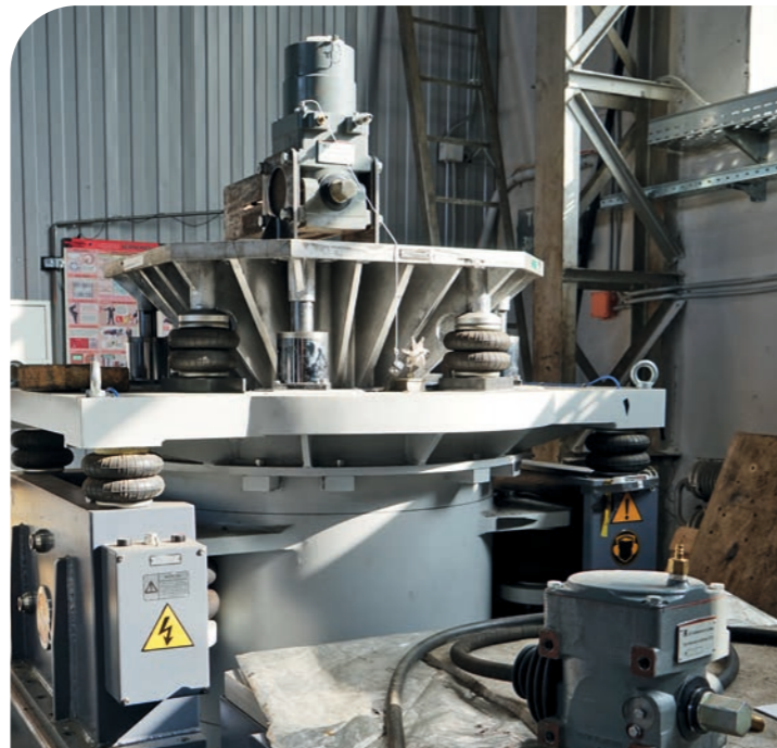
▼ Виброустановка электродинамическая ES-40-445/ВТ1100
