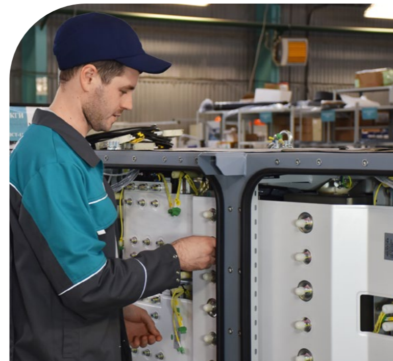
▼ Сборка преобразователя силового инвертора
