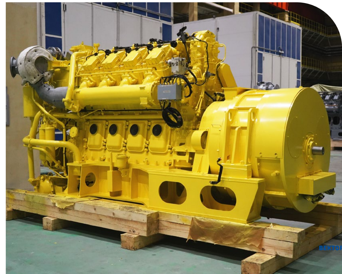
< Среднеоборотный дизель-генератор для БелАЗа 16-36ДГ
