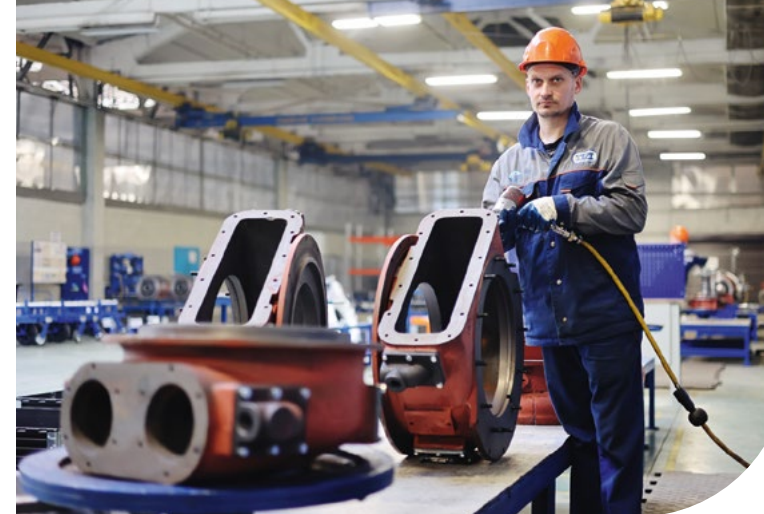
▲ Производство корпуса турбокомпрессора на заводе «Пензадизельмаш»
