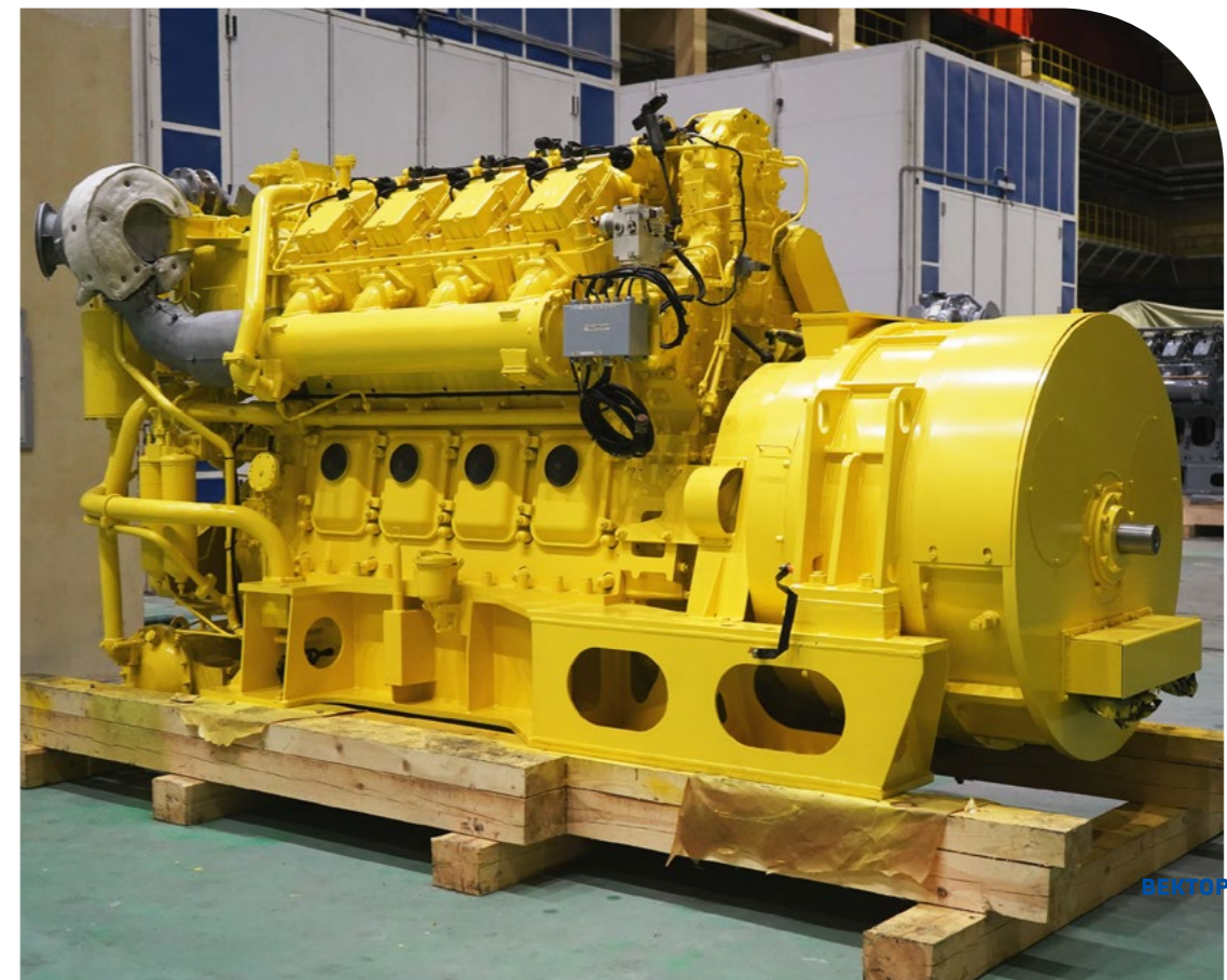
< Среднеоборотный дизель-генератор для БелАЗа 16-36ДГ
