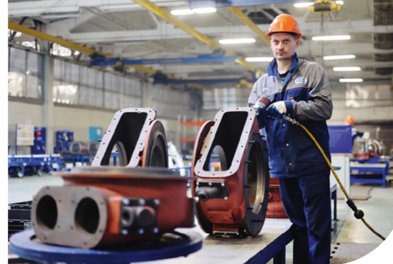
▲ Производство корпуса турбокомпрессора на заводе «Пензадизельмаш»
