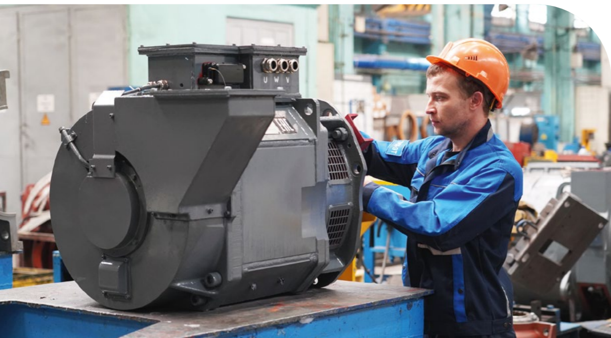
< Асинхронный тяговый электродвигатель ДТА-380У1 для скоростных электропоездов «Иволга 3.0»
