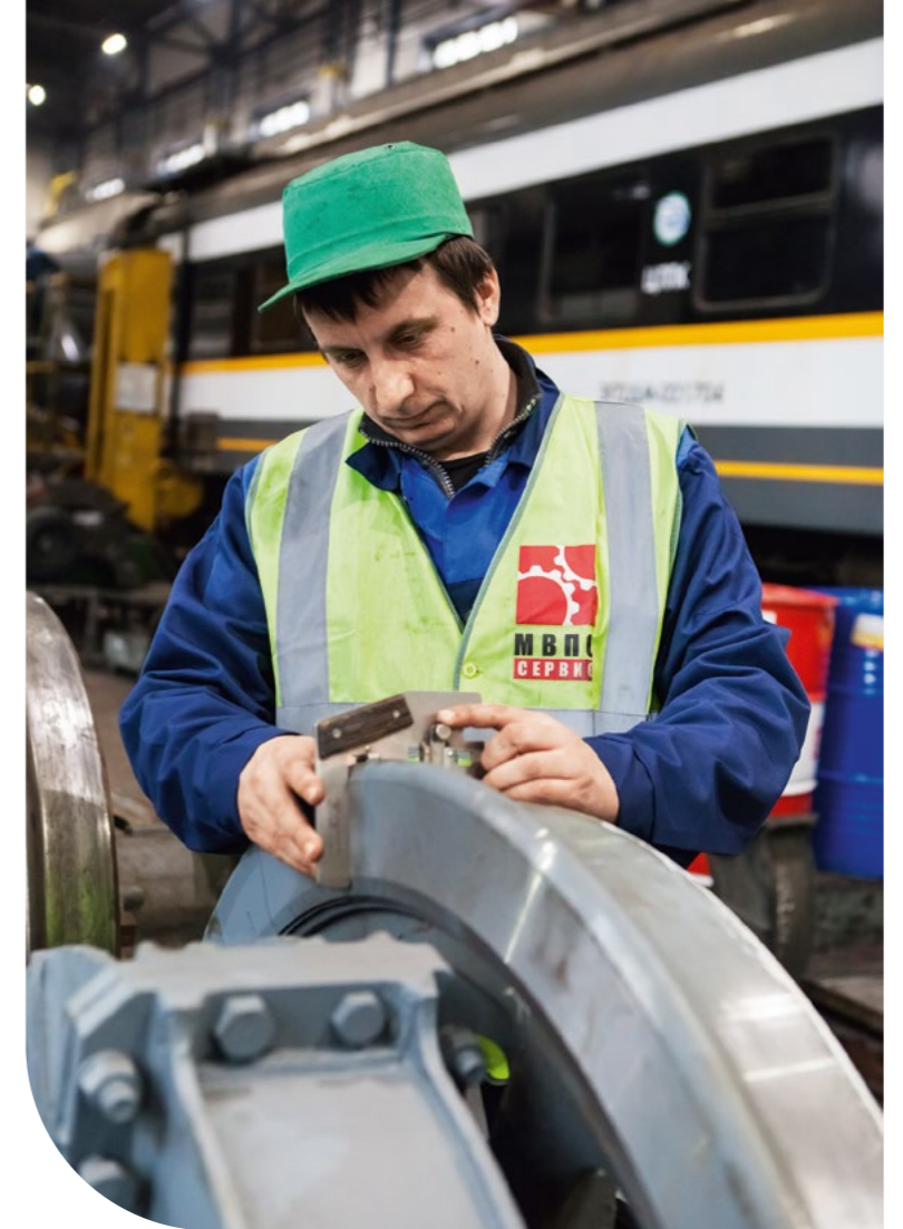
▲ Измерение проката бандажа колеса электропоезда
