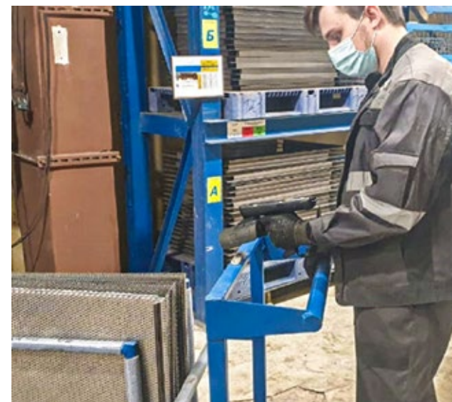
Отгрузка деталей с использованием технологии RFID
