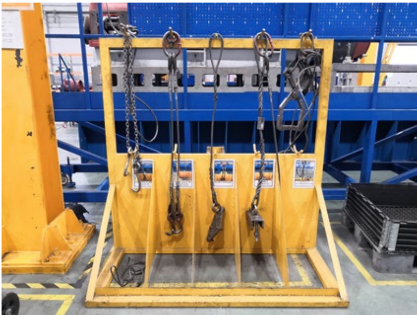
Стенд для грузозахватных приспособлений на сборочной линии дизель-генераторов
