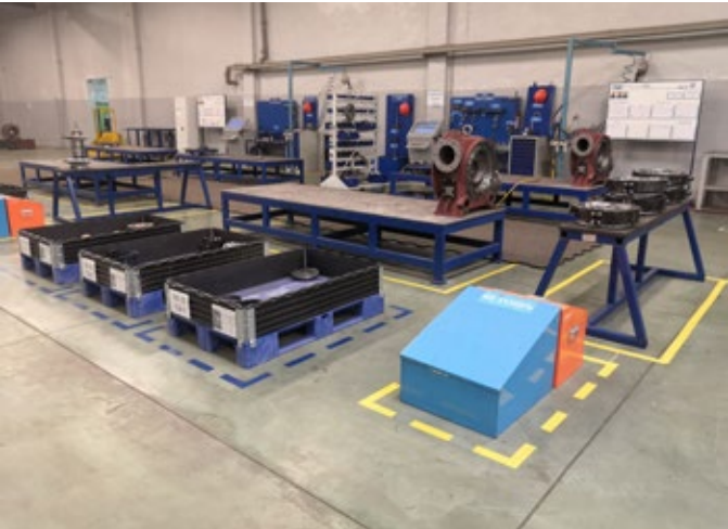
Разметка размещения оснастки на сборочной линии турбокомпрессорного цеха
