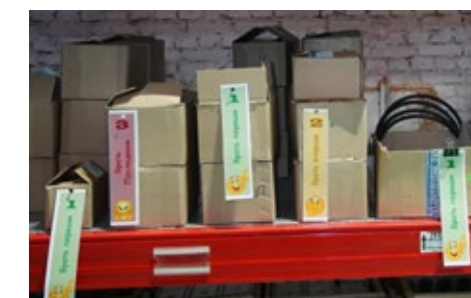
Пример отгрузки деталей по принципу FIFO
