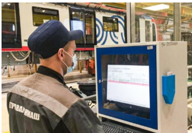
Терминалы для закрытия выполненных операций на сборочных линиях
