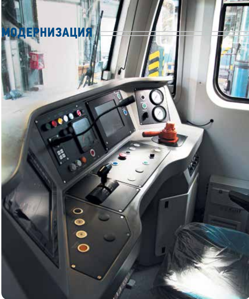
Кабина машиниста после модернизации
