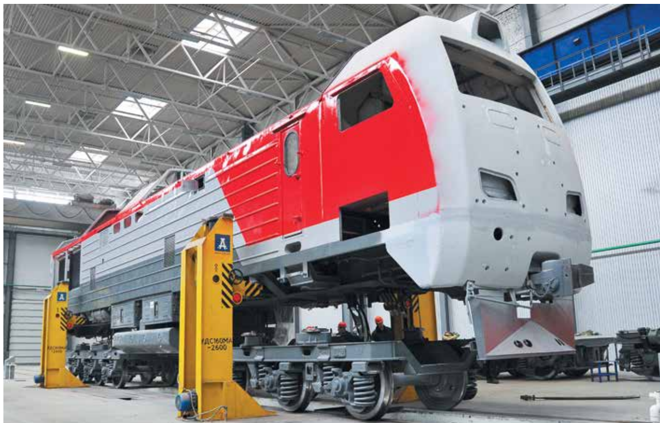
Операция подмены технологических тележек на штатные
