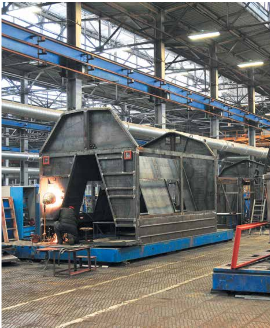
Процесс создания холодильной камеры. Она займет свое место на раме тепловоза
