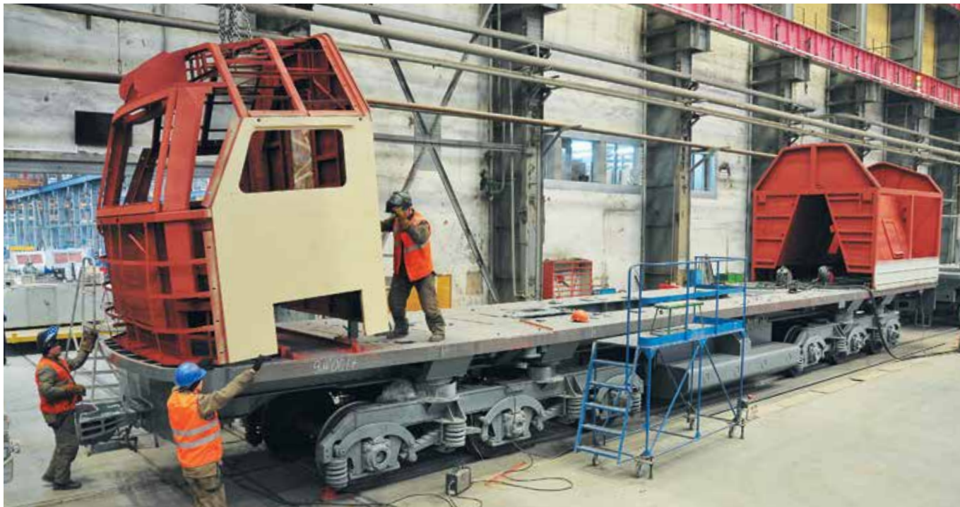
Кабину машиниста как один из основных узлов локомотива устанавливают на раму одной из первых
