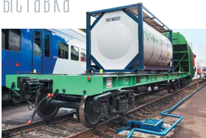
Завод «Трансмаш» из Саратовской области привез на выставку новую платформу, на которой можно перевозить как цистерны, так и контейнеры
