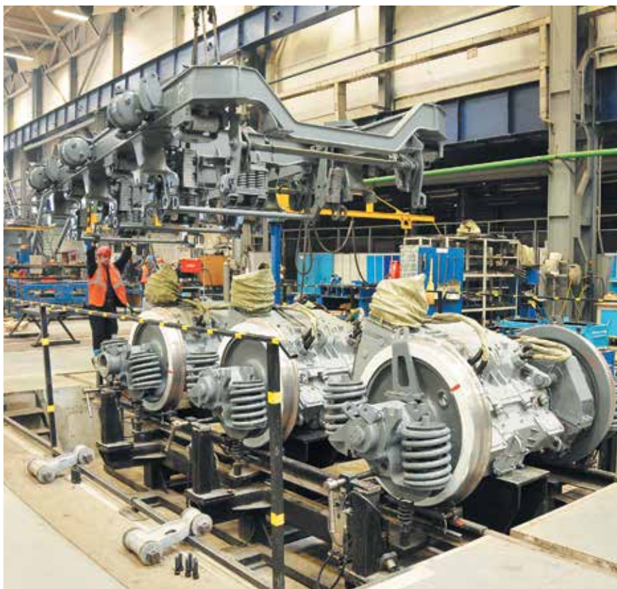
Процесс изготовления тележки близится к завершению. Рабочие готовятся к опуску рамы на колесно-моторные блоки
