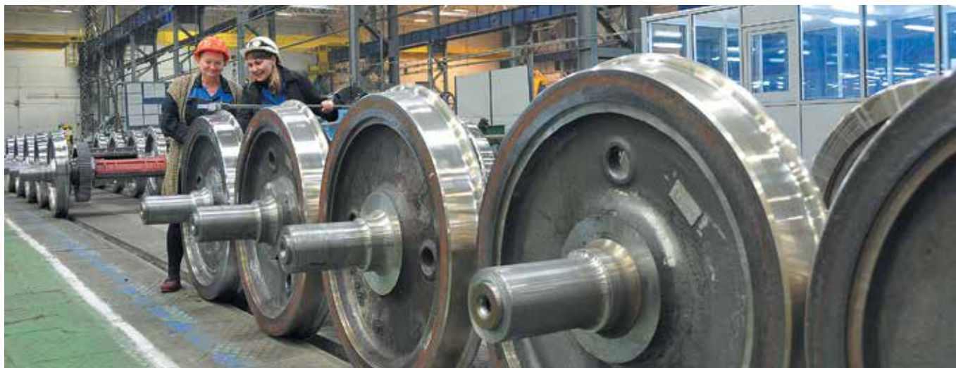
Контрольные замеры бандажей проводят высококвалифицированные специалисты — контрольные мастера
