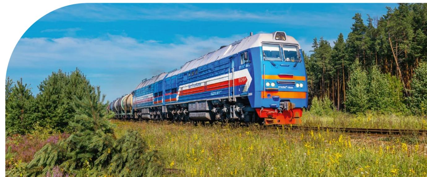
2800 кВт с принудительным охлаждением тормозных резисторов; системы контроля, управления и защиты, выполненные на базе микропроцессорного программно-аппаратного комплекса; винтовой маслonaполненный компрессор повышенной производительности. Всего на БМЗ построили 55 тепловозов 2ТЭ25А.
