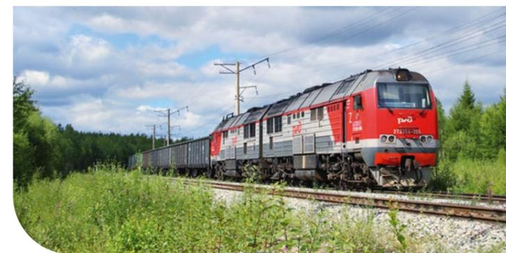
▲ Двухсекционный грузовой тепловоз 2ТЭ25А «Витязь»
