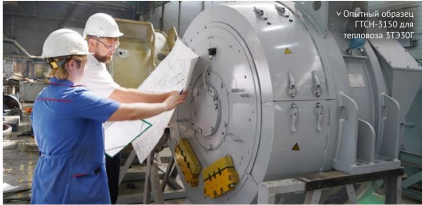
▼ Опытный образец ГТСН-3150 для тепловоза 3ТЭ30Г
