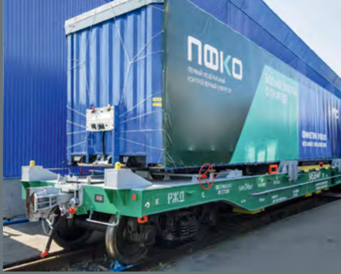
ВАГОН-ПЛАТФОРМА МОДЕЛИ 13-6987 ПРЕДНАЗНАЧЕН ДЛЯ ПЕРЕВОЗКИ АВТОМОБИЛЬНЫХ ПОЛУПРИЦЕПОВ В ГАБАРИТЕ 1-Т И КРУПНОТОННАЖНЫХ КОНТЕЙНЕРОВ
