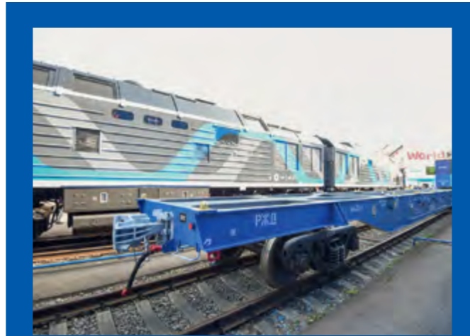
ВАГОН-ПЛАТФОРМА МОДЕЛИ 13-6726 ПРЕДНАЗНАЧЕН ДЛЯ ПЕРЕВОЗКИ КРУПНОТОННАЖНЫХ КОНТЕЙНЕРОВ И КОНТЕЙНЕРОВ-ЦИСТЕРН. ЗА СЧЕТ СНИЖЕННОЙ МАССЫ ТАРЫ В ВАГОНЕ МОЖНО ПЕРЕВОЗИТЬ ДВА ГРУЖЕНЫХ 40-ФУТОВЫХ КОНТЕЙНЕРА МАССОЙ БРУТТО 36 Т. МАКСИМАЛЬНАЯ ГРУЗОПОДЪЕМНОСТЬ ПЛАТФОРМЫ СОСТАВЛЯЕТ 72 Т.
