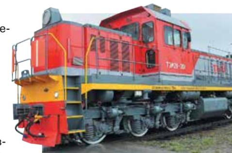
Особое внимание в новом локомотиве конструкторы уделили комфортным условиям работы локомотивной бригады, разработав кабину с круговым обзором. Такое конструктивное решение на БМЗ впервые было применено на тепловозах ТЭМ-ТМХ с модульным принципом компоновки и ТЭМ35 с гибридной силовой установкой. В ближайшее время ожидается отправка нового тепловоза на испытания.
