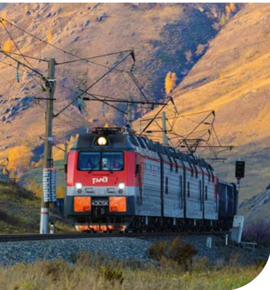
^ Электровоз 4ЭС5К водит тяжеловесные поезда массой до 7100 тонн на сложных участках Восточного полигона РЖД
