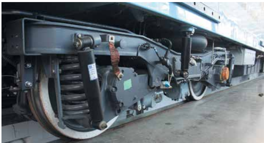
Тележки с пневмоподвешиванием позволяют сделать ход поезда мягким и тихим
