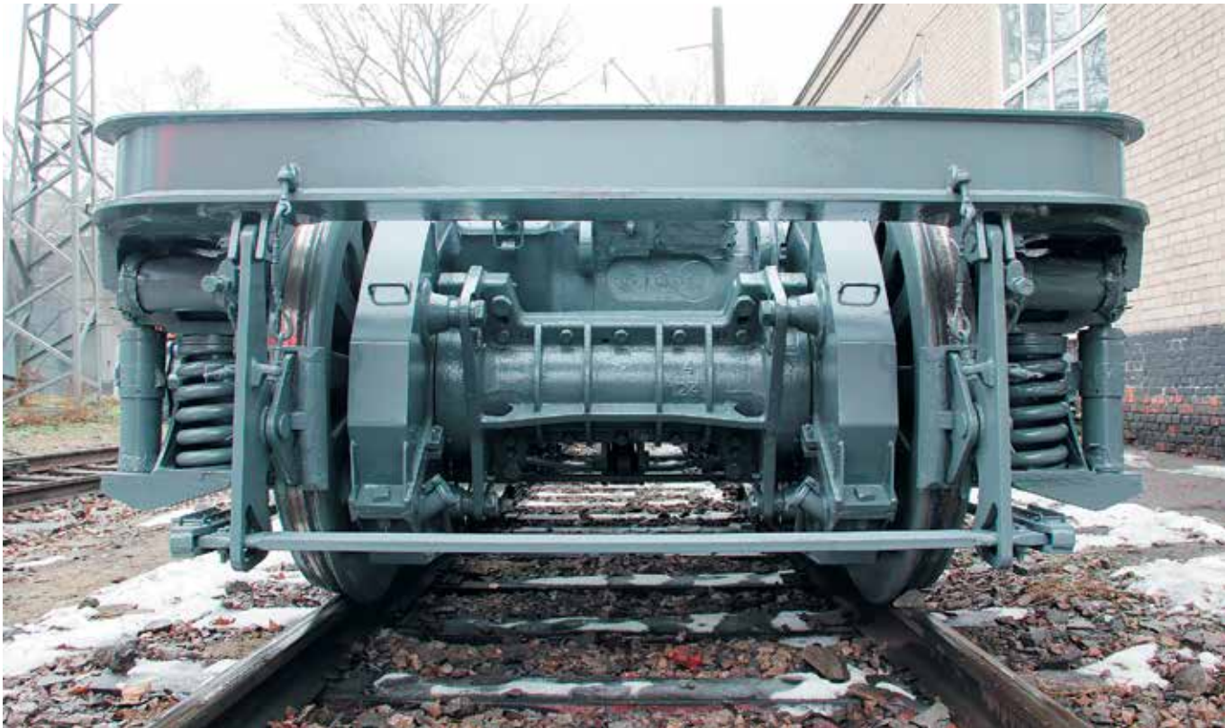
Тележка с колесно-моторным блоком МОП качения
